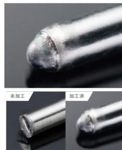
アルミ電解コンデンサの組立工程において、リード端子の先端部がアルミケースと接触し損傷に繋がってしまうことや、封口ゴムの狭い穴への押し込みが難しくなっています。リード端子の先端部に丸目加工を施すことで、組立工程における損傷のリスク低減に貢献しています。
