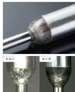
リード端子の錫メッキから、ウイスカと呼ばれる長さ数mm程度のヒゲ状の結晶が発生する場合があります。ウイスカは時間とともに成長し、電子回路や配線をショートさせ、機器の動作不良を引き起こします。当社では、リード端子の溶接部にUV樹脂コーティング処理を施す独自の手法を確立し、ウイスカ発生ゼロを実現しました。
